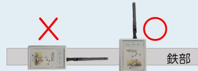
センサー制御装置はアンテナを垂直に立て、磁石でベッドの鉄部に固定します。
